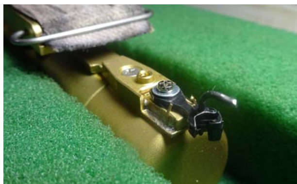
Pliez légèrement les butées pour limiter le débattement de l'attelage
