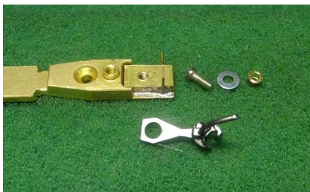
Insertion et soudure de deux butées Ø 0.5 mm
